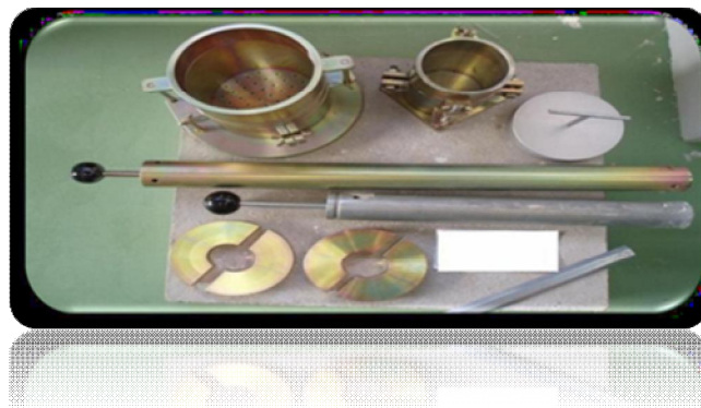
Fig. II.12 : Appareillage spécifique pour essais de compactage (Proctor Normal).
