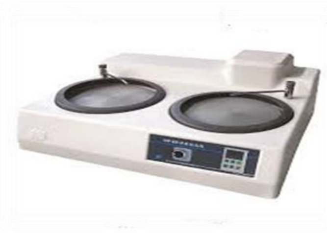
الشكل II.3: جهاز الصقل الميكانيكي من نوع MP-2B Grinder Polisher .
