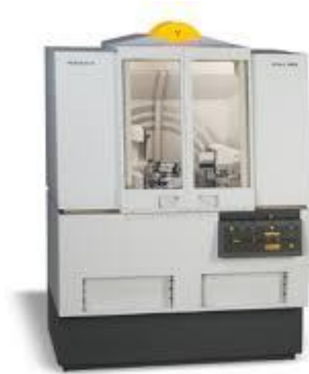
الشكل 9.II: جهاز حيود الأشعة السينية من نوع panalytical x'pert pro.
