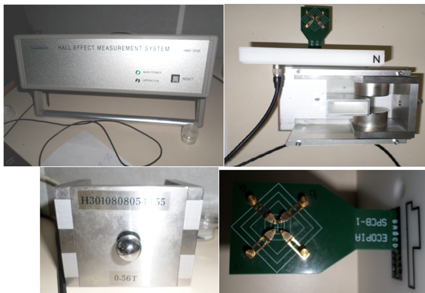
FIGURE 2.12 – Dispositif d'effet Hall avec la géométrie de van der Pauw-Montpellier.
