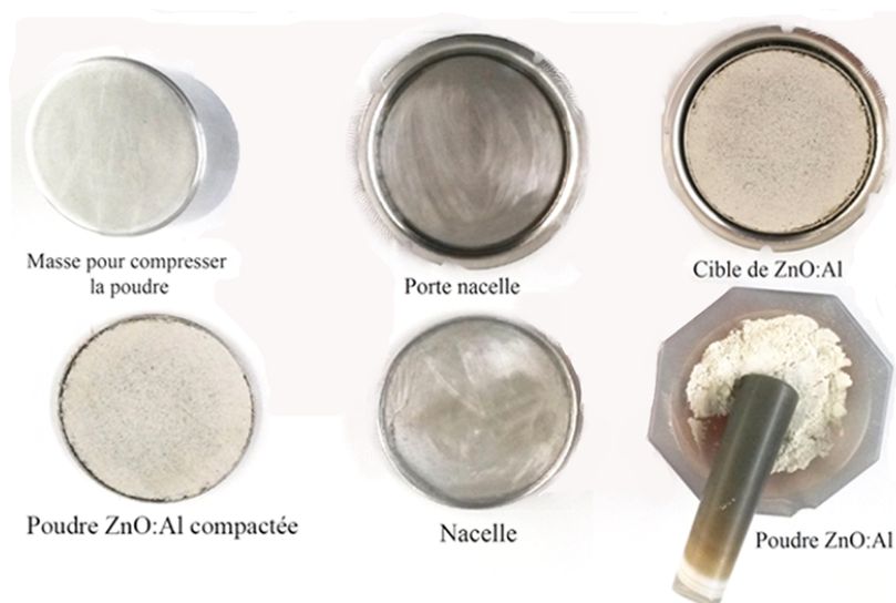
FIGURE 2.8 – Cible de nanopoudre de ZnO:Al compactée dans une nacelle.
