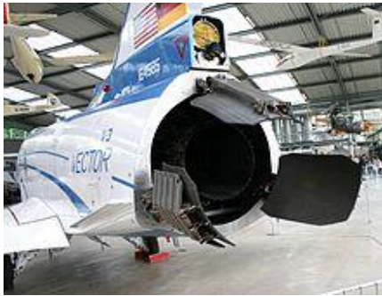
Fig.1 a) Réacteur de l'avion de Rockwell-MBB X-31 capable de réaliser une poussée vectorielle tridimensionnelle. b) Moteur d'avion F-22 est capable de produire deux poussées vectorisées, [United Technologies Corporation – Pratt & Whitney Division].
