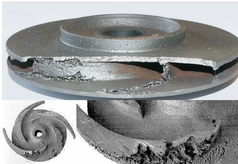
Figure 2.10 : Dégâts par cavitation
