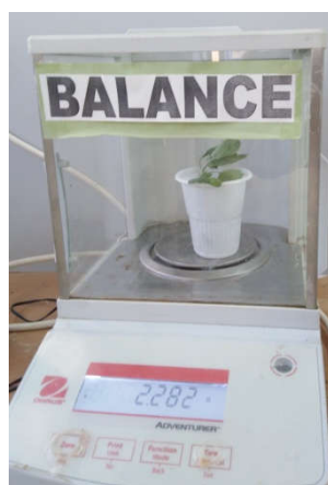
Fig. 25. Mesure le poids frais de quinoa (photo originale).
