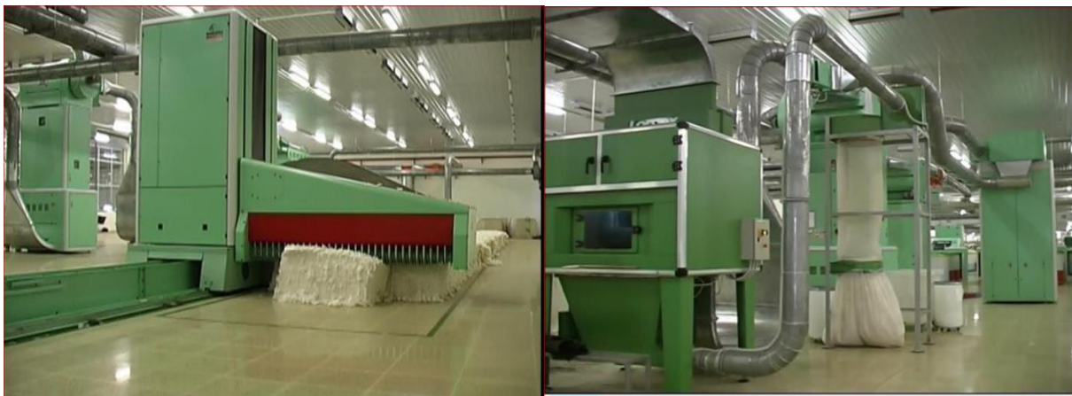
Figure 14: Machine Battage de la société EATIT (Brise balles) (Nettoyeuse).
