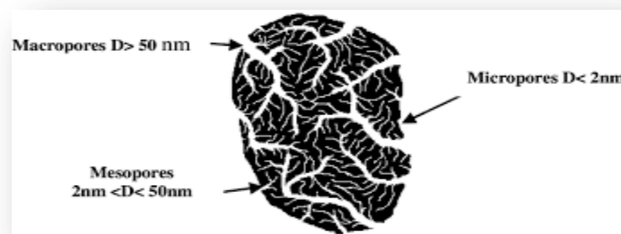
Figure III. 4: Représentation schématique des différents types de pores
