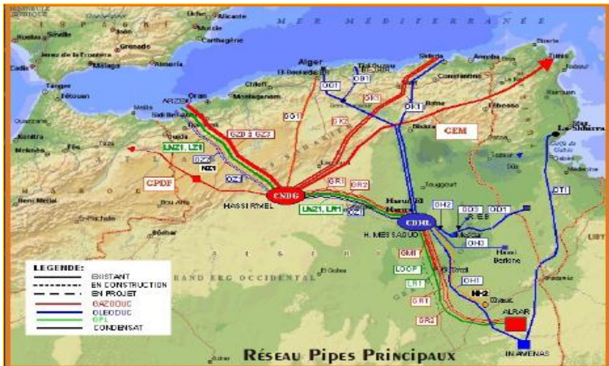
Figure (1.2) : Réseau de transport par canalisation
