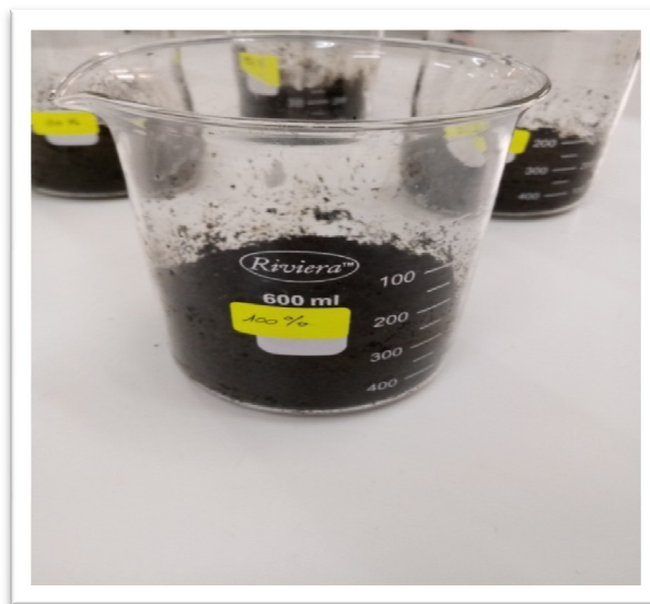
Figure II.6 : L'activation chimique par \text{H}_3\text{PO}_4 .
