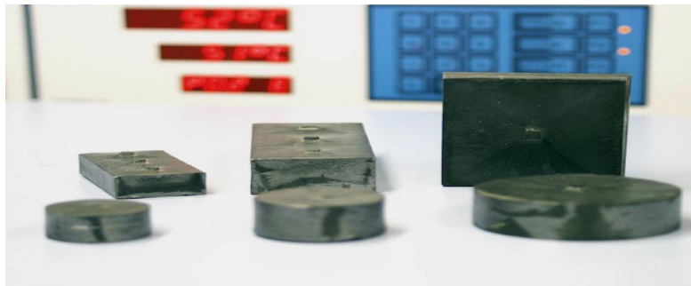
Figure III.2. Exemple de matériaux supraconducteurs massifs de composition YBCO, [23].
