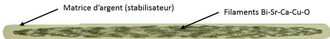
Figure III.3. Section d'un ruban supraconducteur BSCCO de type H (SUMITOMO®), [26].
