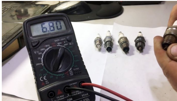
Figure IV.5: Mesure des résistances avec un multimètre
