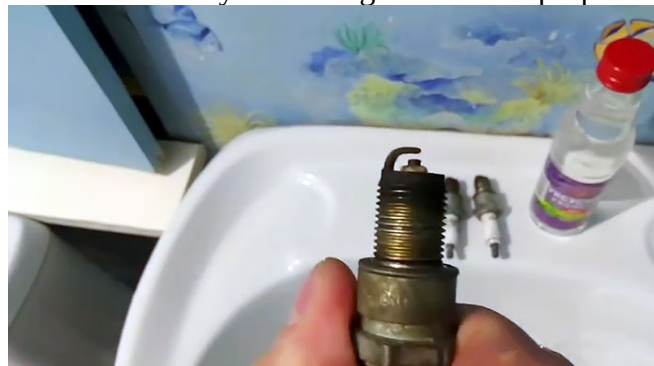
Figure N°IV.1 Nettoyage de la bougie d'allumage
