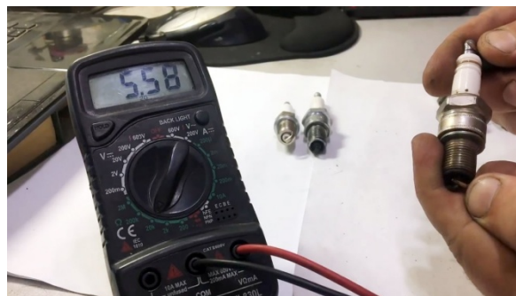
Figure IV.6: Mesurer des la résistance interne
