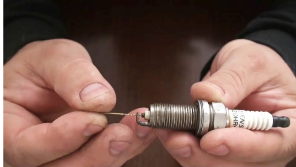
Figure IV.7: Perçage de l'électrode négatif
