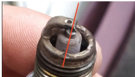
Figure IV.8: Axe de perçage de l'électrode négatif
