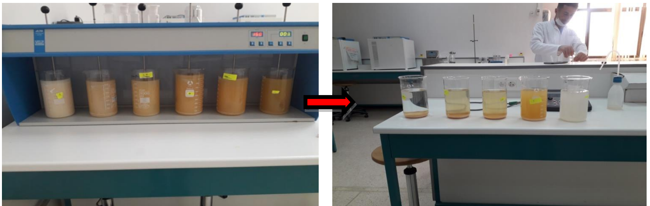
Figure IV.10 : Effet du pH initial sur l'élimination de la turbidité en fonction du temps
