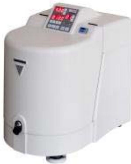
الشكل (2.III): ساحق آلي من نوع Planétaire (pulverisette 6)
