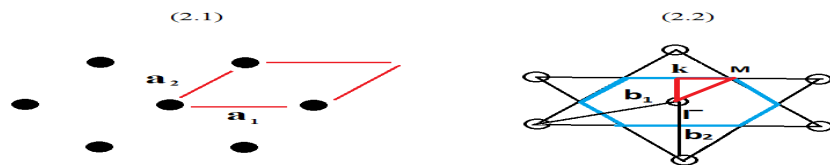
Figure I.20 : (2.1). Réseau hexagonale avec a_1 = a_2 = a , (2.2) le réseau réciproque avec
