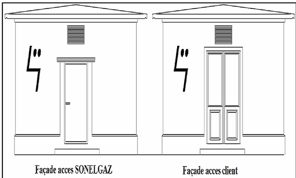
Figure (III.46) Vue de faces d'un poste livraison à comptage MT
