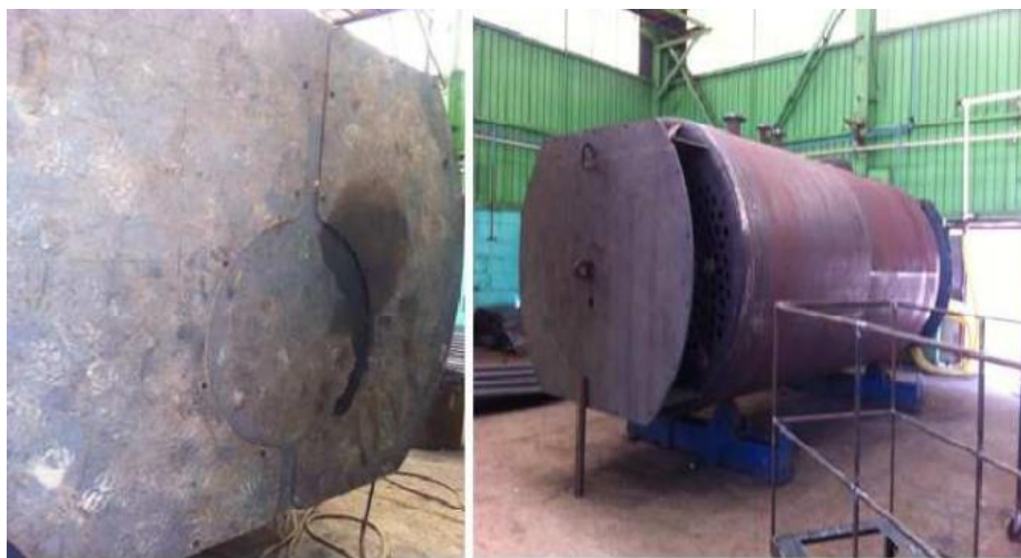
Figure IV.10. Boîte de retour, foyer et portes montés [1].
