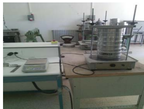
Figure II.3. Appareillage d'analyse granulométrique (tamisage).
