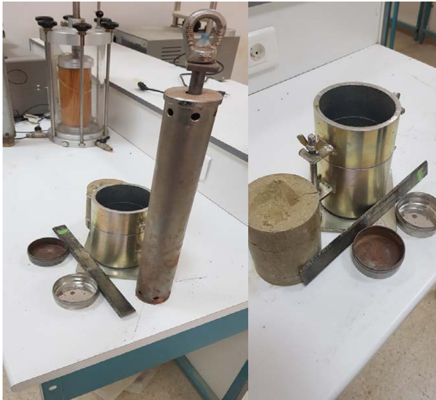
Figure II.9 Appareillage spécifique pour essais de compactage (Proctor Normal).
