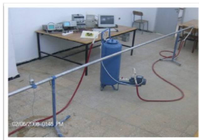
Figure (II.21) Prototype du circuit hydraulique global réalisé
