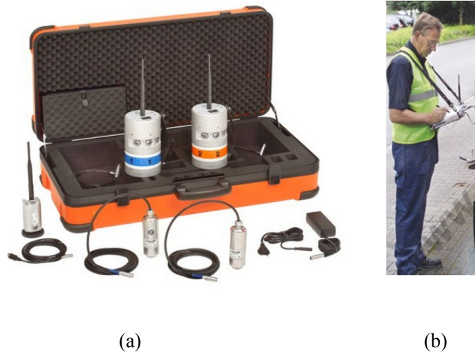
Figure (I.11) Détecteur SeCorr 300 Avec son corrélateur portable (a) Capteurs, (b) Corrélateur [29]
