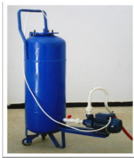
Figure (II.15) Réservoir d'eau
