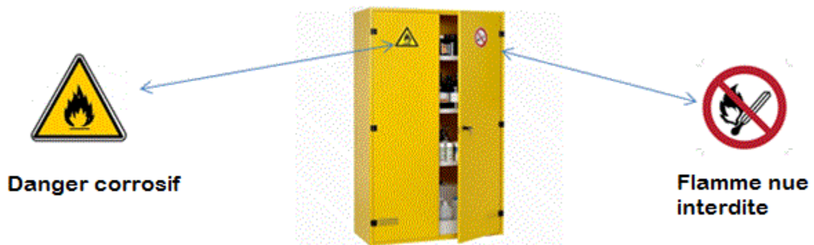
Figure 4 : Signalisation d'armoires pour Produits inflammables
