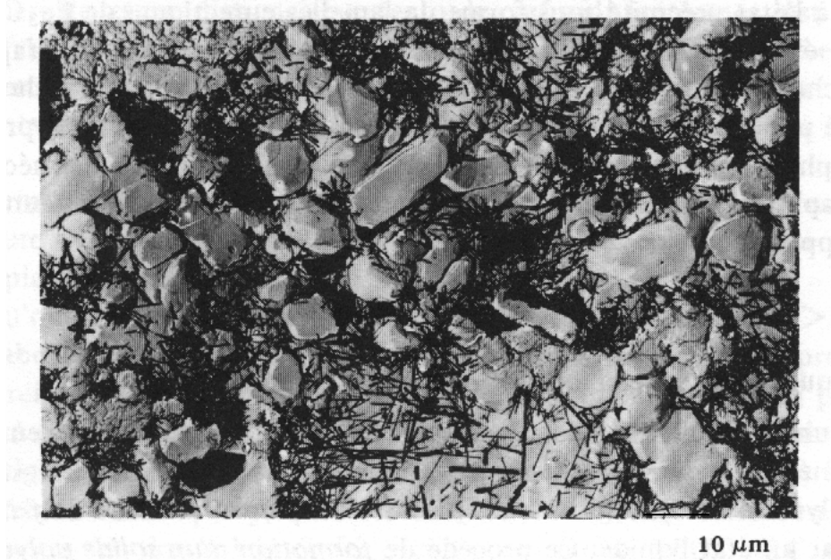
الشكل 10.II: البنية المجهرية للبورسلان المركب مع بلورات كوارتز [87] .
