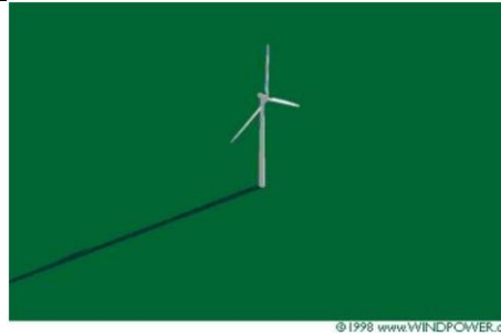
Figure II-6 : Projection d'ombres d'une éolienne [17]
