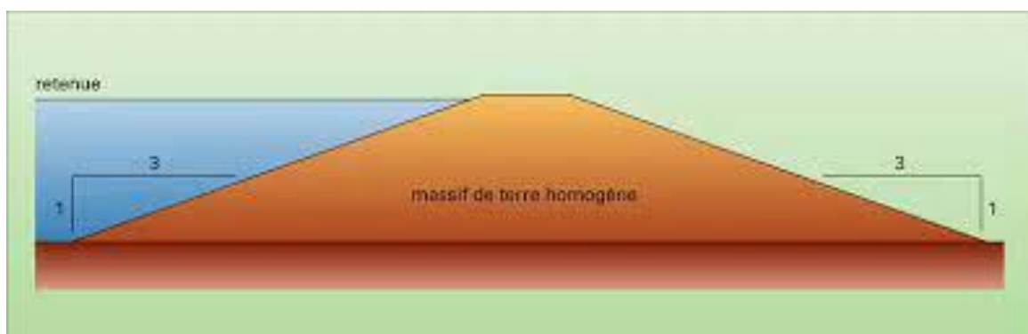
Fig. I.2 Digue en terre, profil homogène
