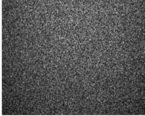
Fig 2.2 Figure de speckle produite par une plaque d'Aluminium recouverte d'une poudre blanche diffusante.
