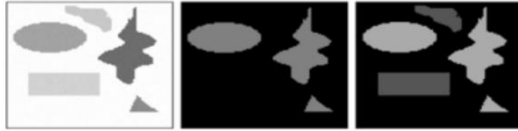
Figure 1.11 : (a) l'image originale, (b) l'image classée par K-means avec K=3 , (c) l'image classée par k-means avec K=5
