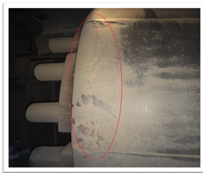
Figure II-11 : Profil du bandage fissuré.
