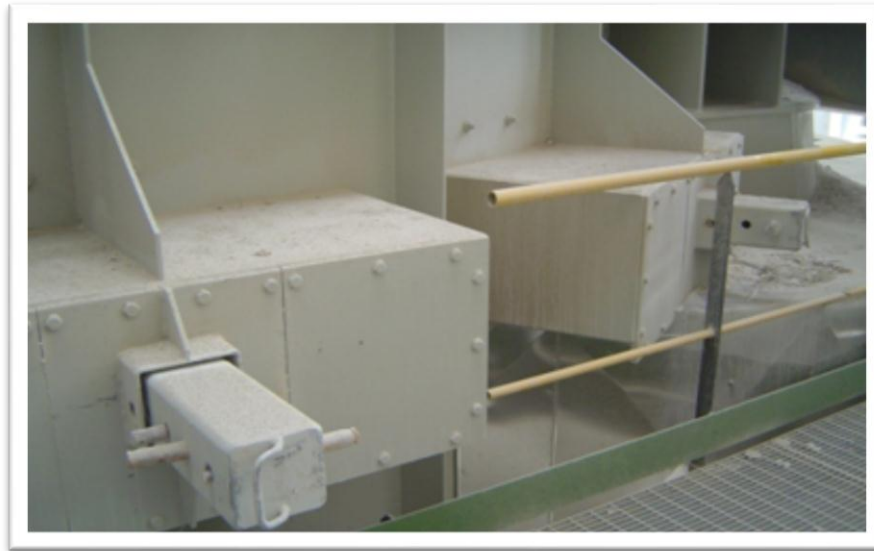
Figure II- 6 : Position de tiroir de réglage pour l'anneau de buse.
