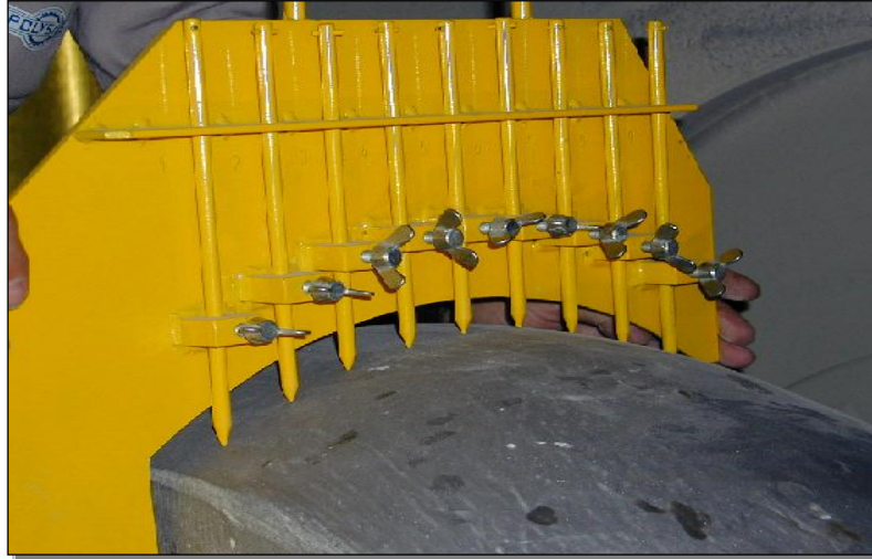
Figure II-18 : Gabarit de mesure de la taille d'usure du bandage [1]
