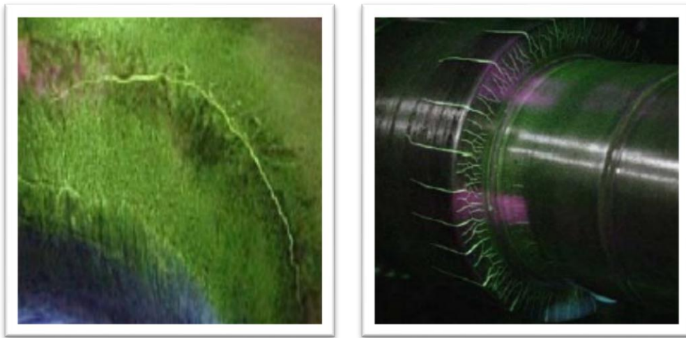
Figure III-3 : Contrôle par magnétoscopie [3]
