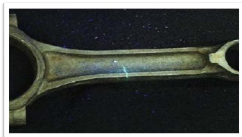
Figure III - 1: Contrôle par ressuage. [3]
