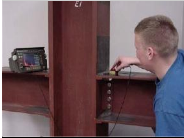
Figure III - 5: Contrôle par ultrason. [3]
