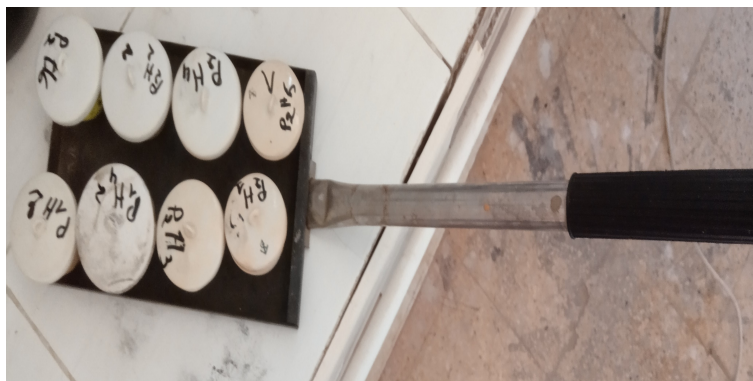
Figure 10.3 : Les échantillons du gypse mis au four (photo original).
