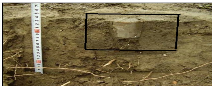
Figure 15 .3 : Cylindre enforcé dans le sol (photo original).
