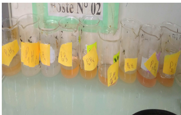
Figure 12.3 : Titration de Carbonate et bicarbonate (photo original).
