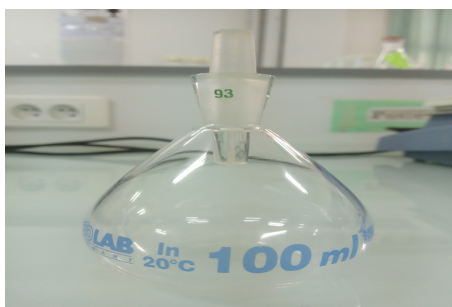
Figure 14.3 : Pycnomètre utilisé pour la détermination de la densité réelle de nos échantillons
