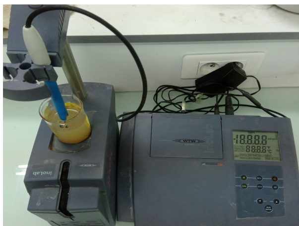
Figure 5.3 : pH-mètre juste avant la détermination de pH de nos échantillon (photo original).
