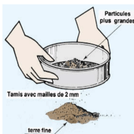
Figure 4.3 : Préparation de l'échantillon à analyser (tamisage)
