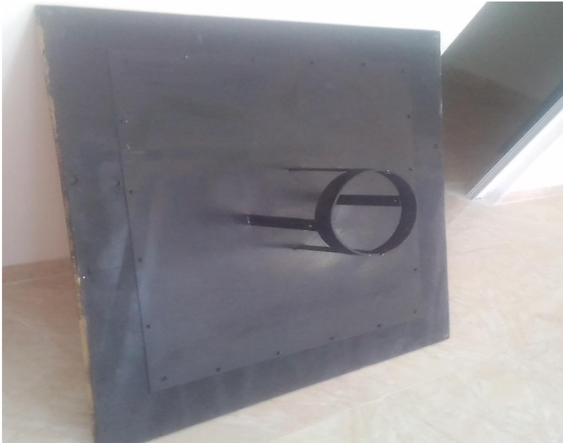
Figure (II-9) : Support de cheminée fixé sur la planche en bois ainsi que les tiges filetées
