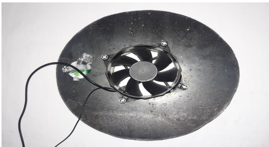
Figure (II-12) : ventilateur pour la Prototype Cheminée Solaire
