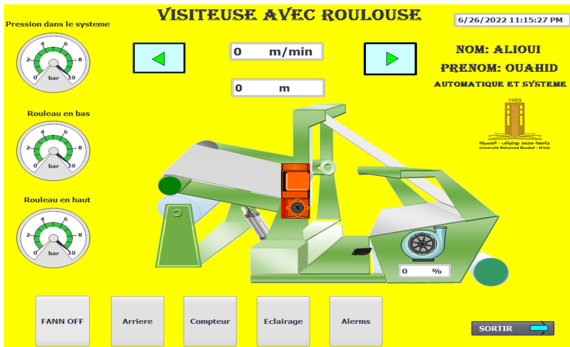
Figure IV.7: Supervision par WINCC Runtime
