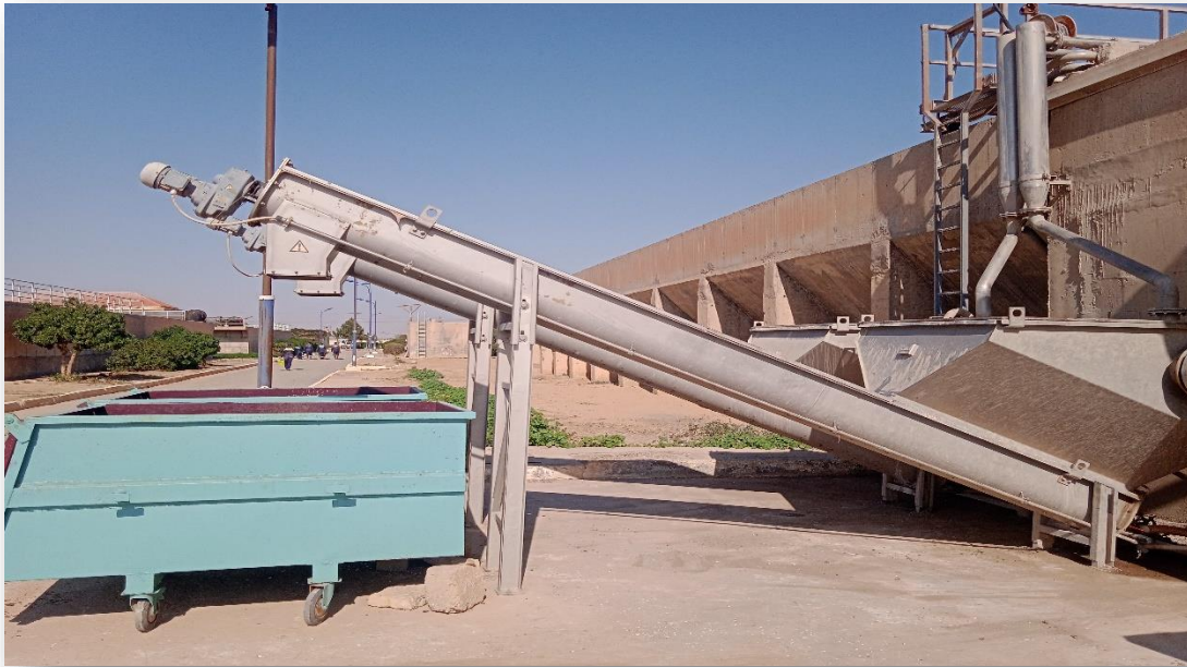
Figure III .07: Mécanisme de l'extraction du sable (calibreur de sable)
