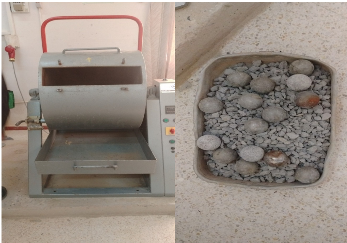
Figure III.6 Appareil de l'essai Los Angeles.
