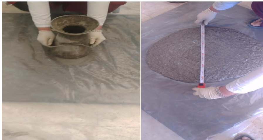
Figure I.9 Détermination de l'étalement.
