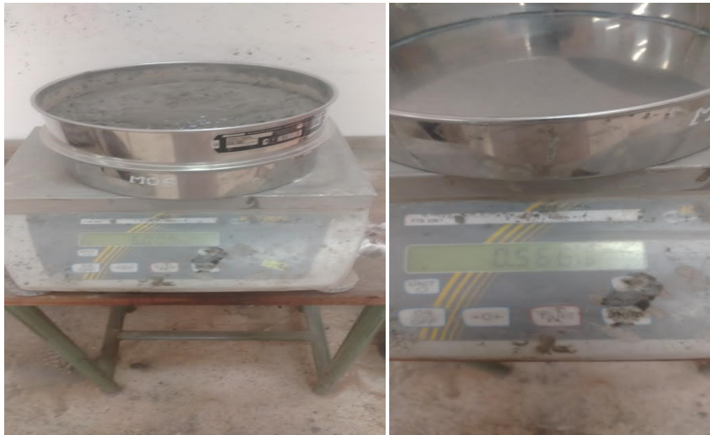
Figure I. 13 - Représentation de l'essai de stabilité au tamis
