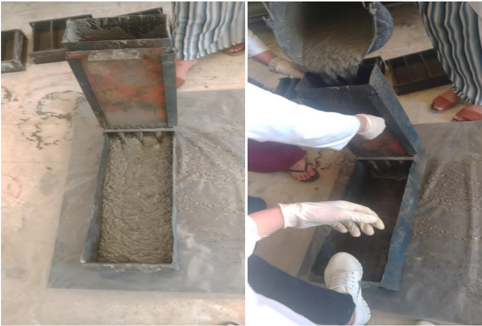
Figure I. 11 Représentation de l'essai à la boîte en L
