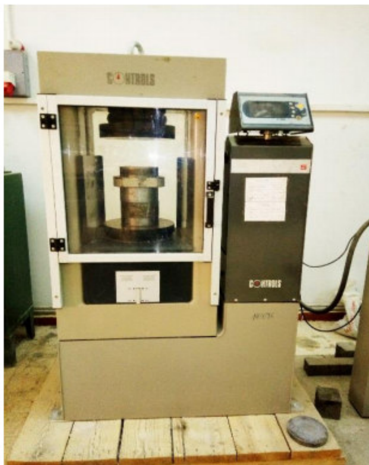
Figure. IV.7. L'appareil de l'essai de compression
