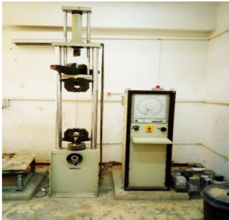
Figure.IV.8. L'appareil de l'essai de traction par flexion
