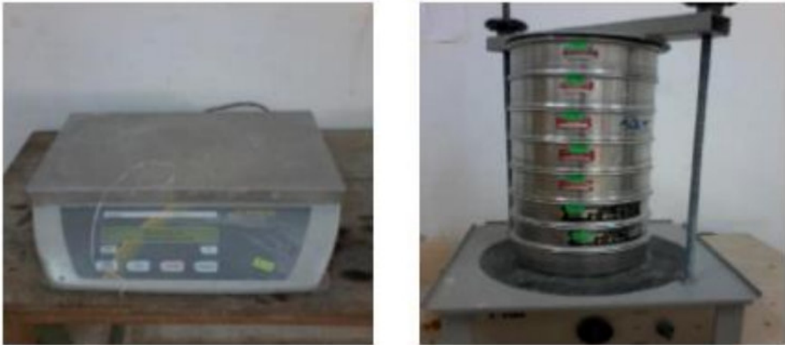
Figure III.1 Matériels utilisés pour l'analyse granulométrique
