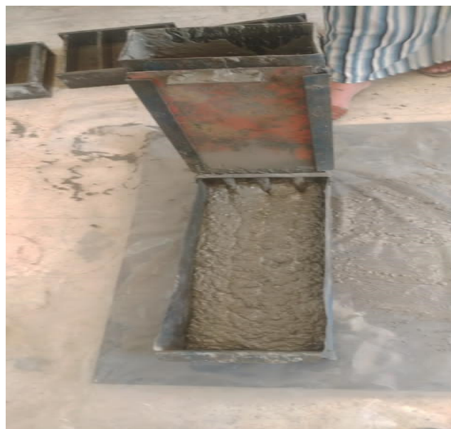
Figure. IV.4 .exemple de l'essai la boîte en L
