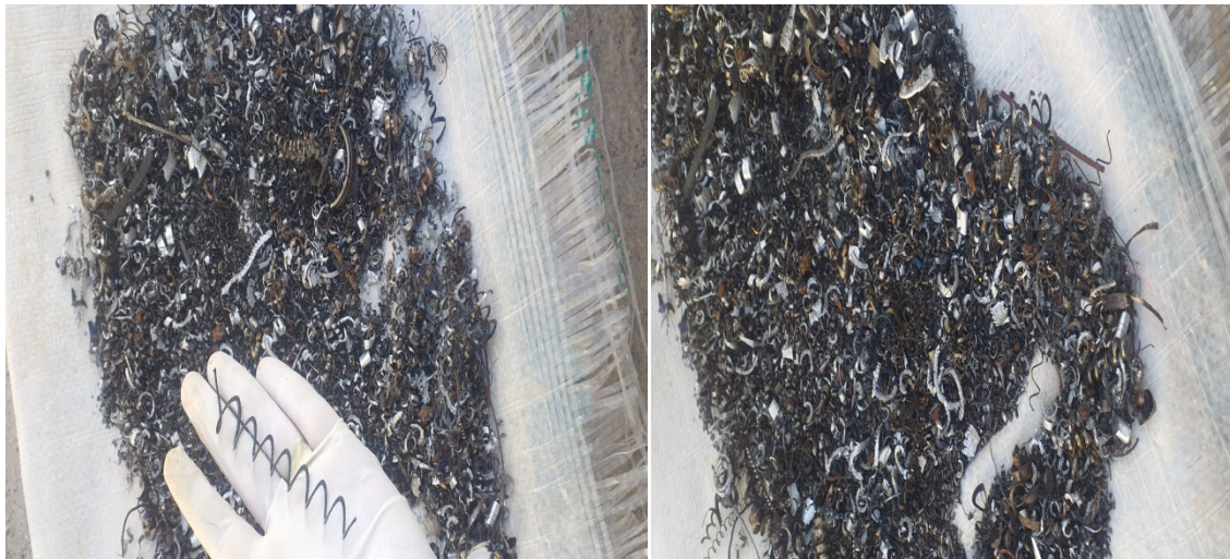
Figure III.8 Les copeaux métalliques
