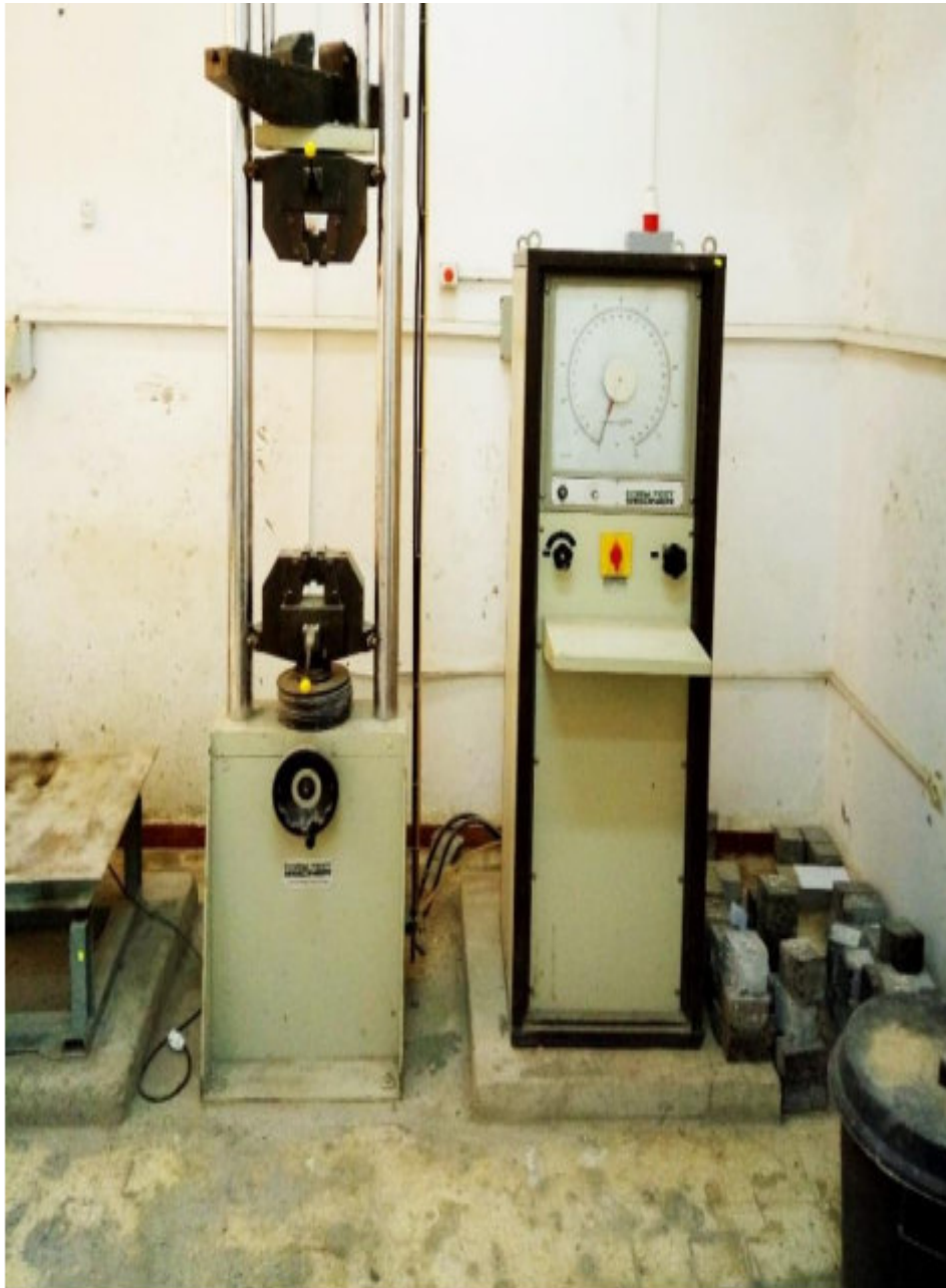
Figure. I. 18 : Mesure de la résistance à la traction par flexion [2]
