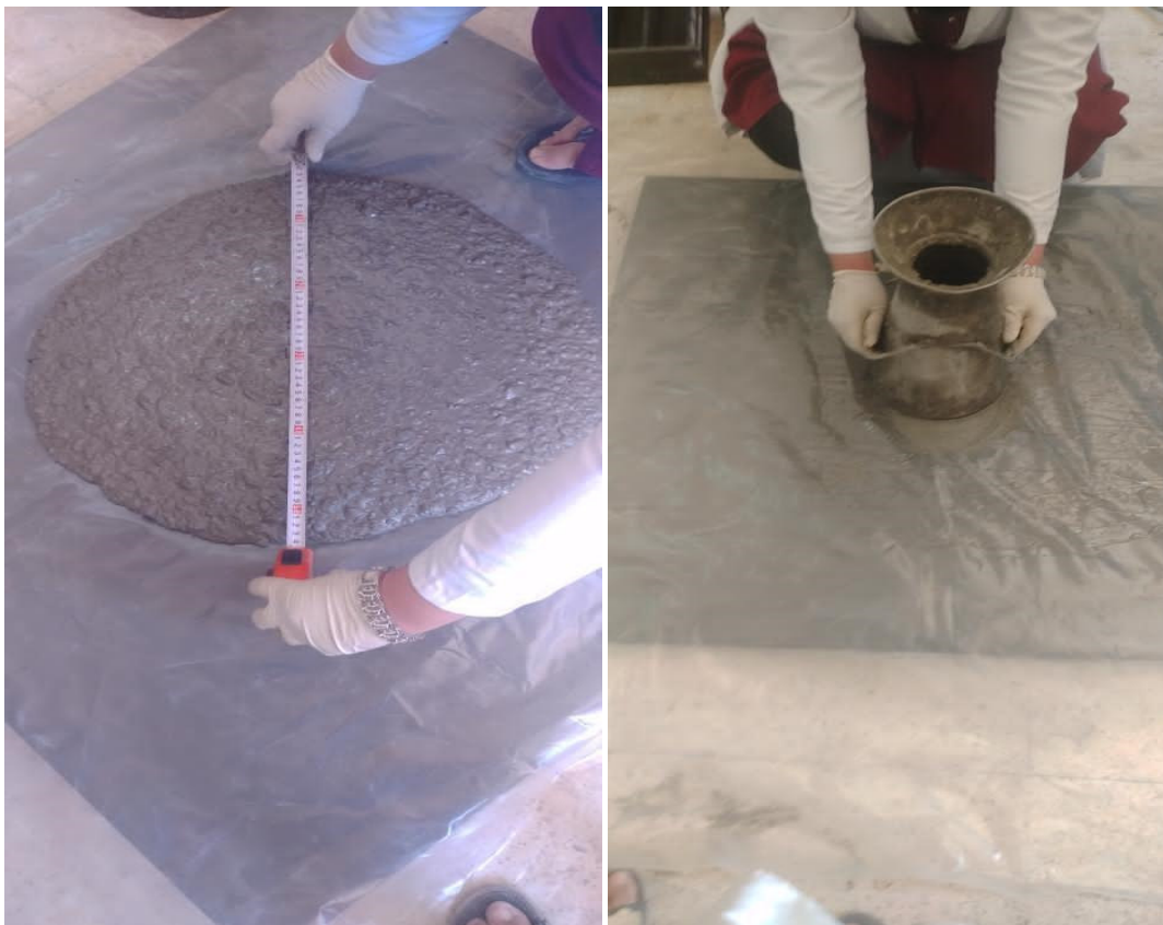
Figure. IV.2. Exemple d'étalement d'un BAP
