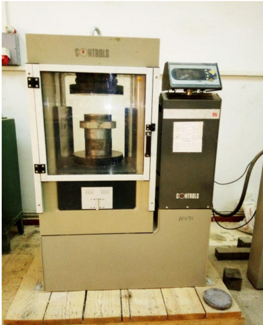
Figure. I.17 Mesure de la résistance à la compression.[2]
