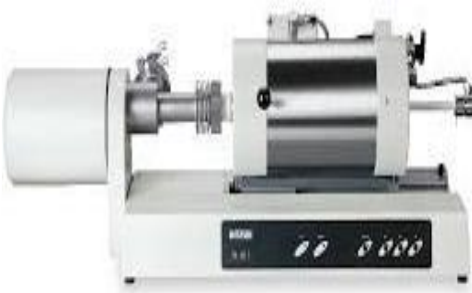
الشكل (9.II): جهاز التمدد الطولي التفاضلي النسبي
