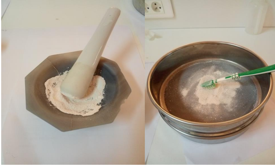
الشكل (2.II) : يبين أدوات السحق التقليدية
