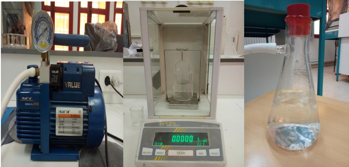
الشكل (6.II): الوسائل المستعملة لقياس الكتلة الحجمية
