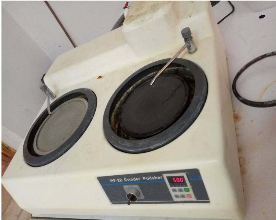
الشكل (7.II): جهاز الصقل الميكانيكي
