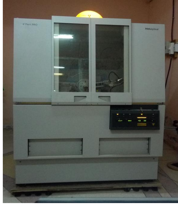
الشكل (5.II): يبين جهاز حيود الأشعة السينية X pert pro panalytical
