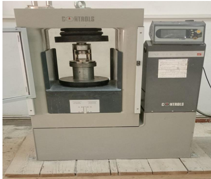
Figure III.16 : Essai de résistance à la compression
