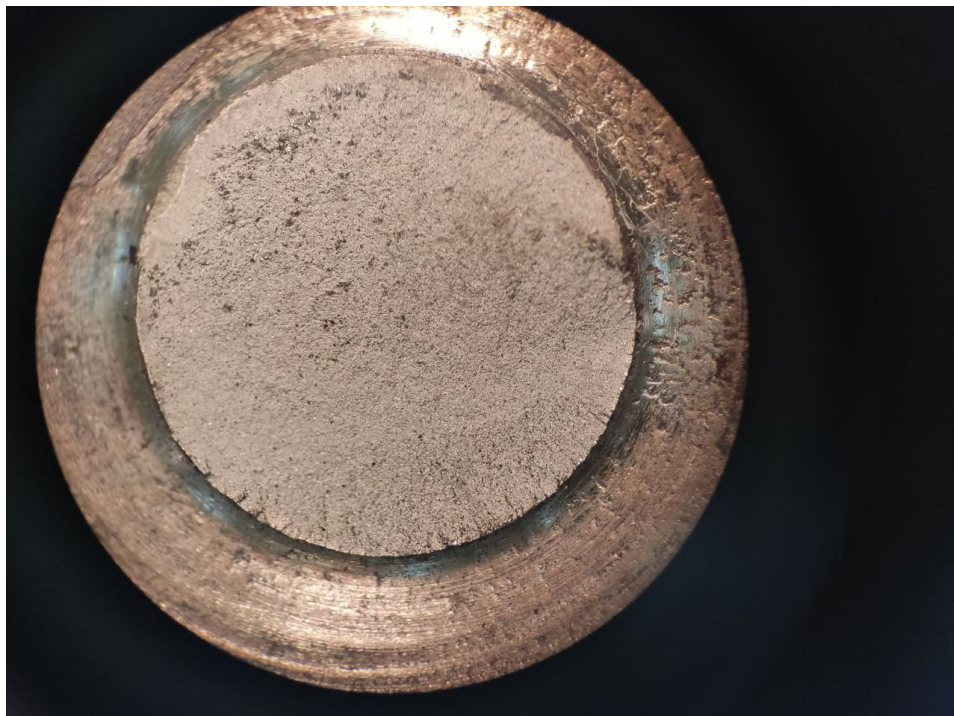
Figure III.15 Photomicrographie optique (grossissement, x20) de faciès de rupture d'une éprouvette d'essai de fatigue en flexion rotative sous une charge de 180 N et Ra = 0.075 après 48623 cycles de l'acier XC 48 trempé à 850\text{ °C} et revenu à 570\text{ °C} ( Hv=247 ).
