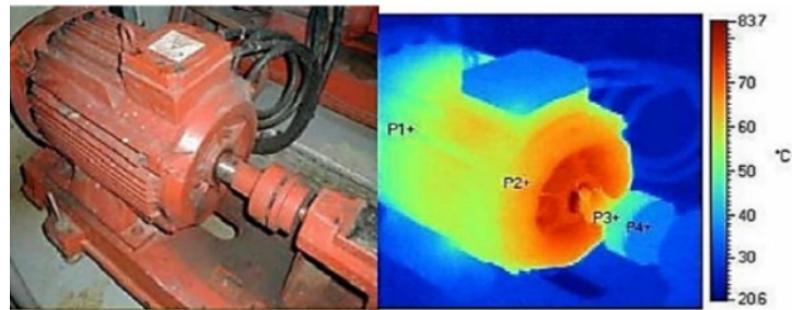
Figure IV.10 : exemple de défaut de roulement d'un moteur électrique
