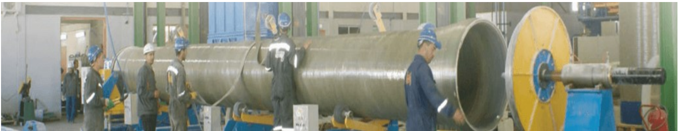
Figure III.6 : Machine à enroulement filamentaire discontinu
