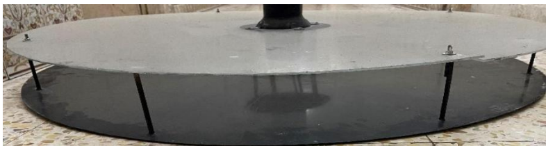
Fig III.1. : Le collecteur et l'absorbeur. [2]
