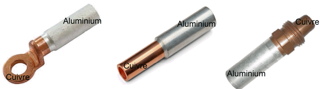
Figure I.11. Connecteurs bimétalliques fabriqués par soudage par friction rotative [6].
