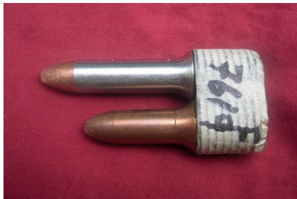
Figure I.14. Joint AISI 304L/Cuivre soudé par friction rotative après le test de traction [21].
