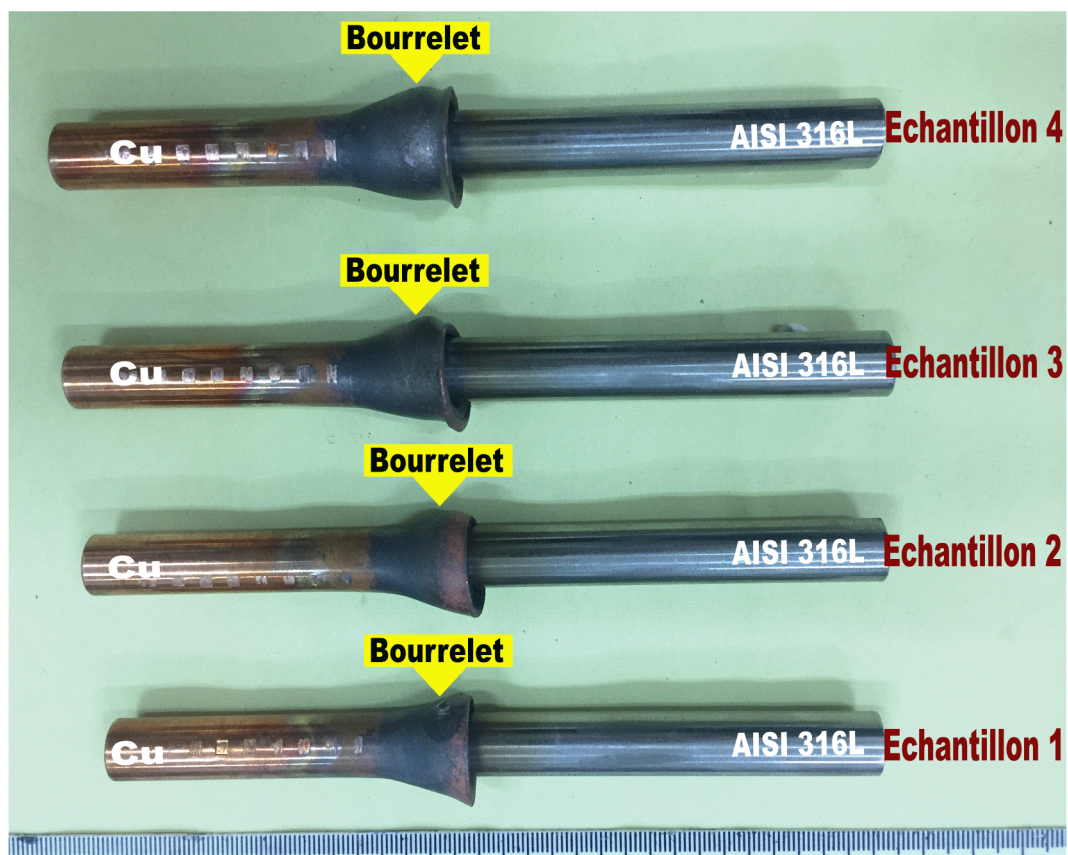
Figure III.1. Echantillons acier inoxydable AISI 316L/cuivre soudés par friction rotative.
