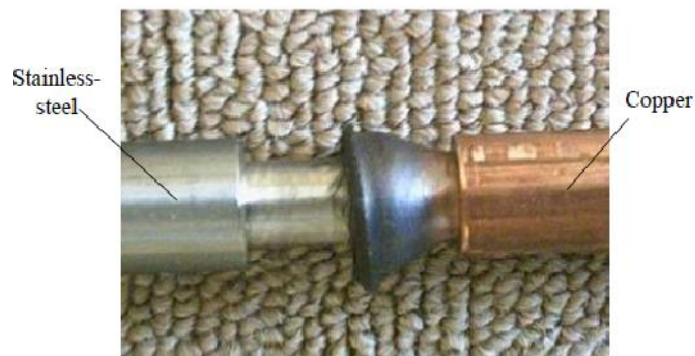
Figure I.12. Joint AISI 304/Cuivre soudé par friction rotative [19].
