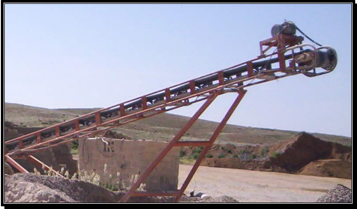
Fig. III.1 : Convoyeur à bande dans la station.
