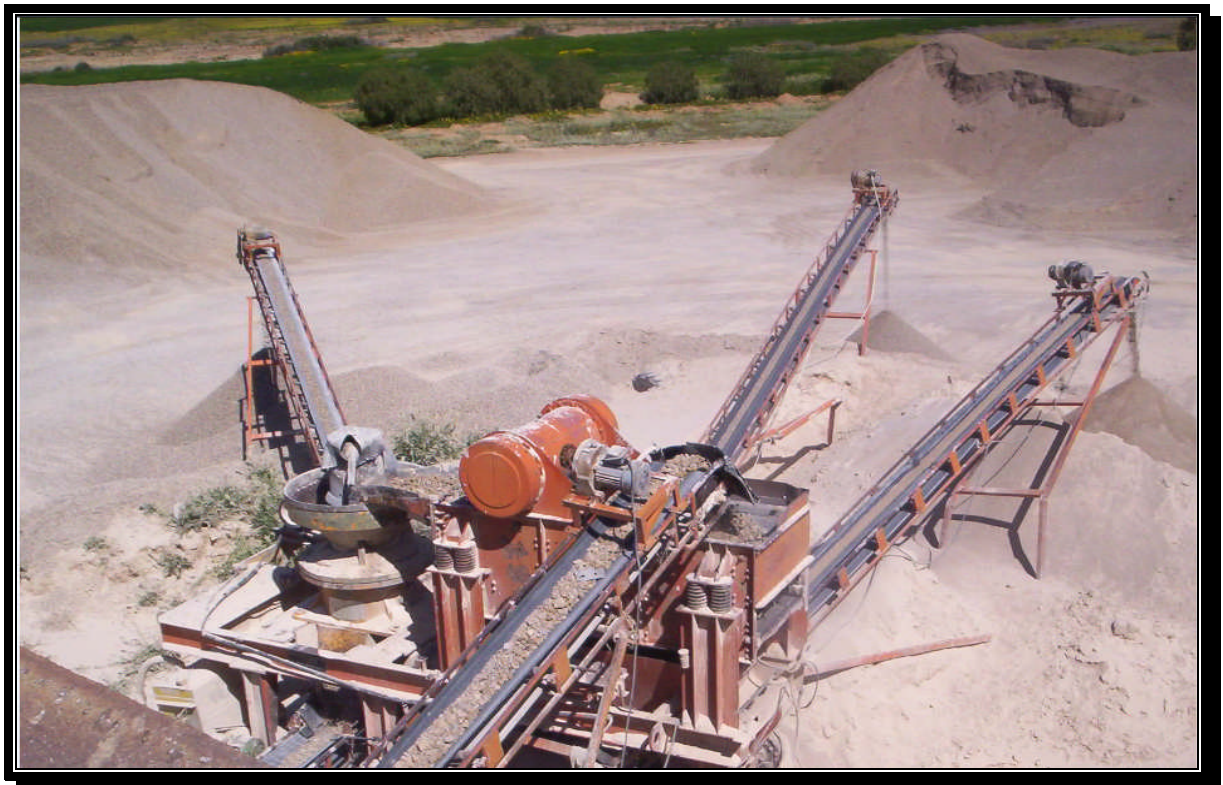
Fig. II.7: convoyeur à bande entre le concasseur principal et le crible a quatre étages.
