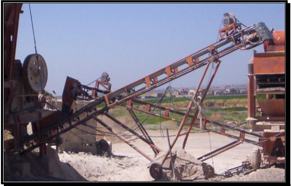
Fig. II.7: convoyeur à bande entre le concasseur principal et le crible a quatre étages.
