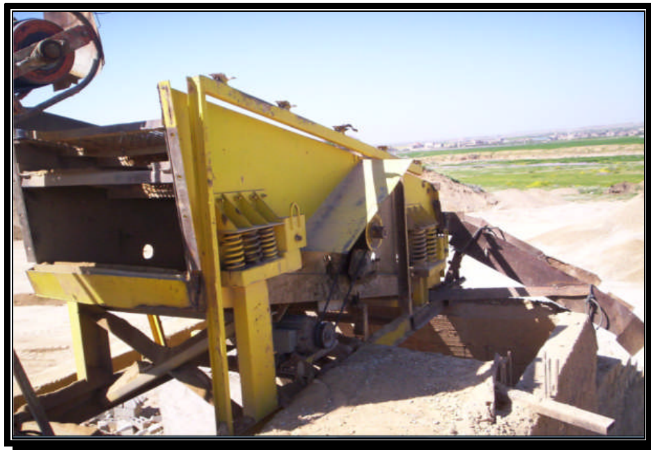
Fig. II.10: Crible à deux étages.
