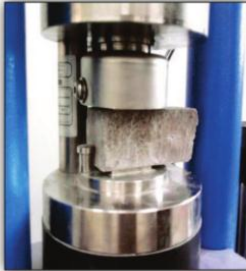
Figure IV. 11 Eprouvette testée en compression.
