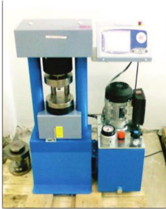
Figure IV. 5 Appareil de compression et de flexion des mortiers.
