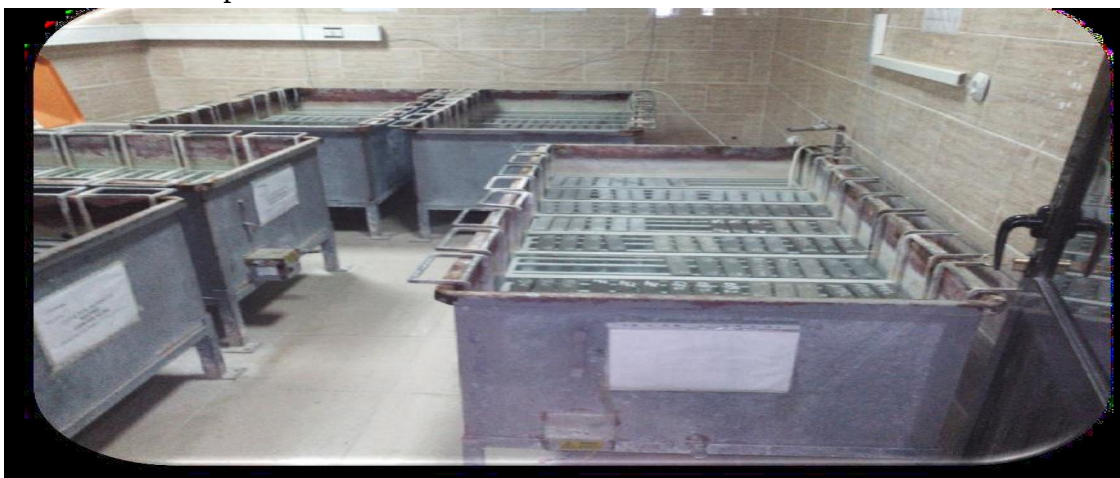
Figure IV. 3 Conservation des éprouvettes dans l'eau.
