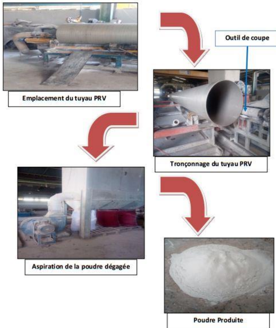
Fig.17 : Obtention de poudre fibres de verre. [2]
