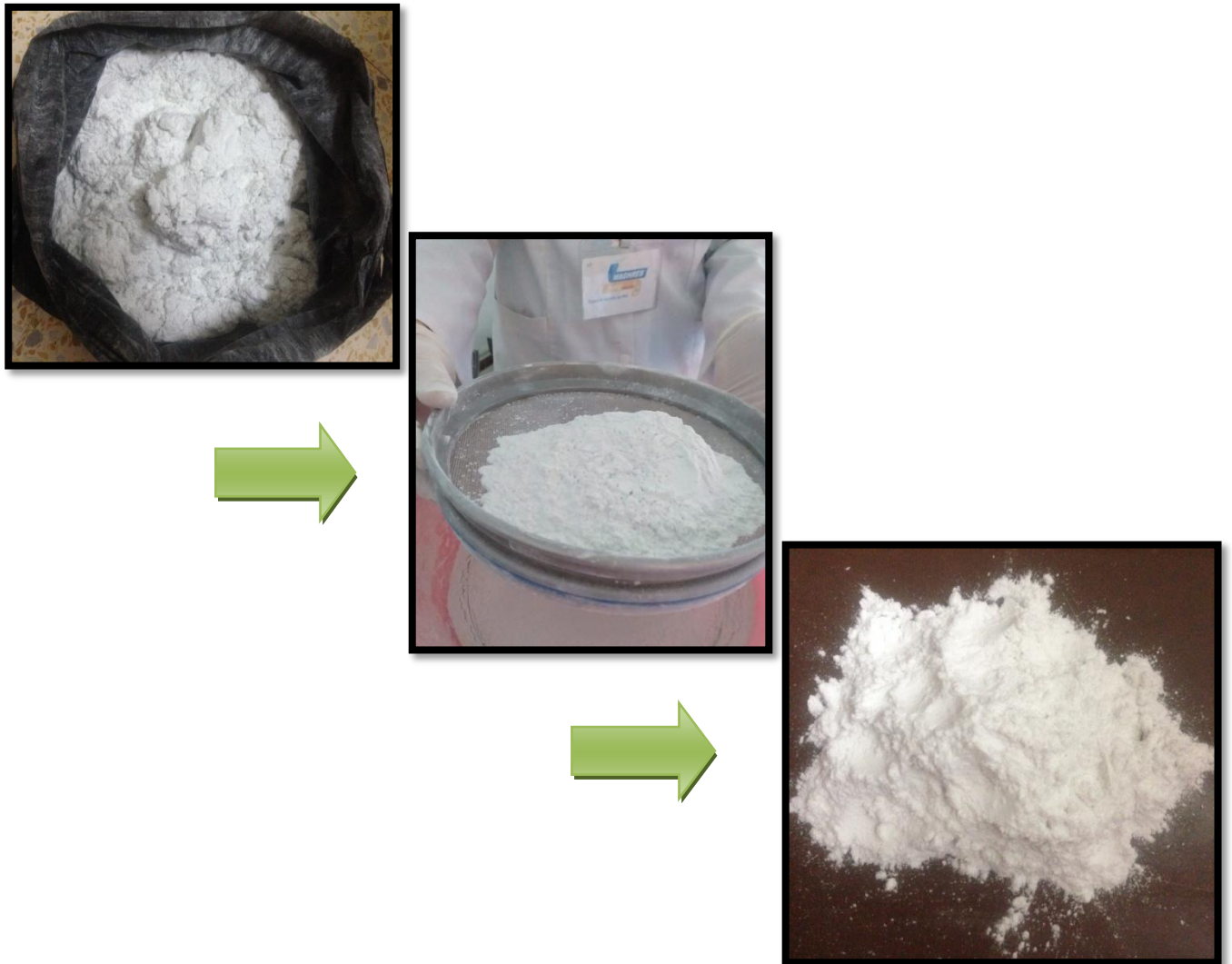
Fig.18 : Les étapes de préparation des déchets.
