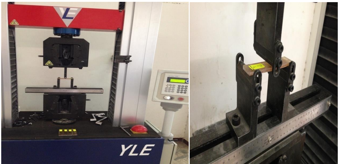
Fig.25 : Essais de flexion trois points sur de matériau composite étudié.
