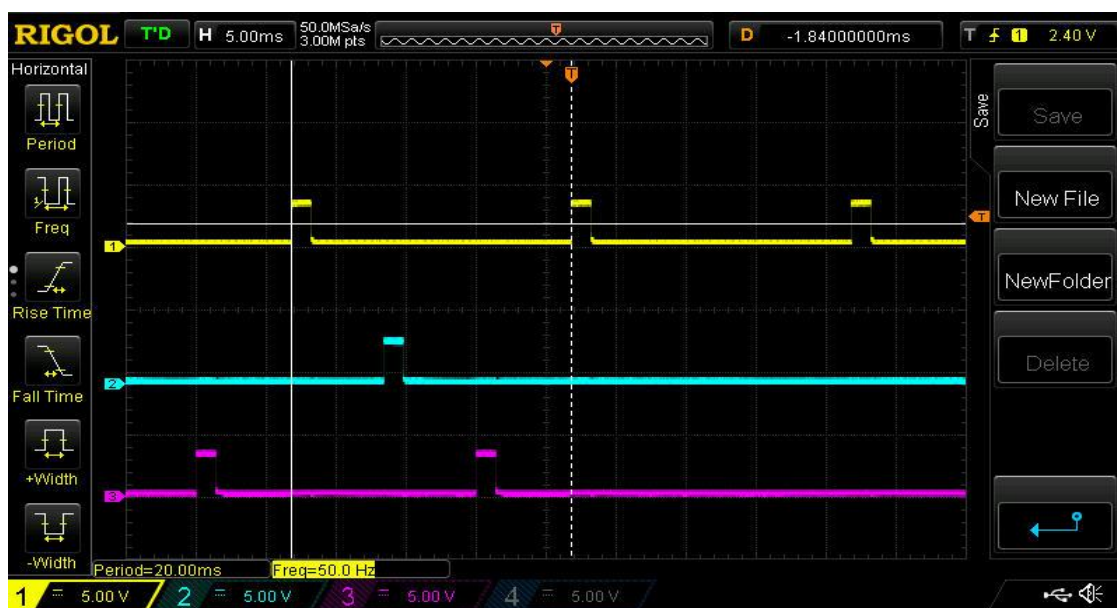
Figure III.7 Les résultats des essais du transformateur d'impulsions.
