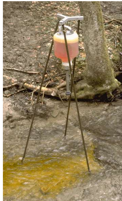
Fig. 3.6. Jaugeage à débit constant.
