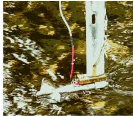
Fig. 3.2. Adaptation du moulinet aux différents modes opératoires.
