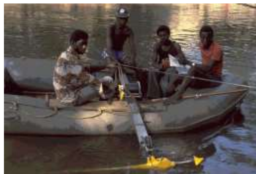
Fig. 3.3. Jaugeage au moulinet à l'aide d'un bateau.
