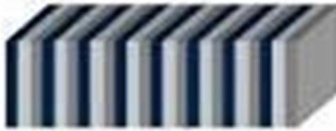
Figure I.2: structure unidimensionnelle formée par l'empilement de couches de propriétés élastiques différentes.
