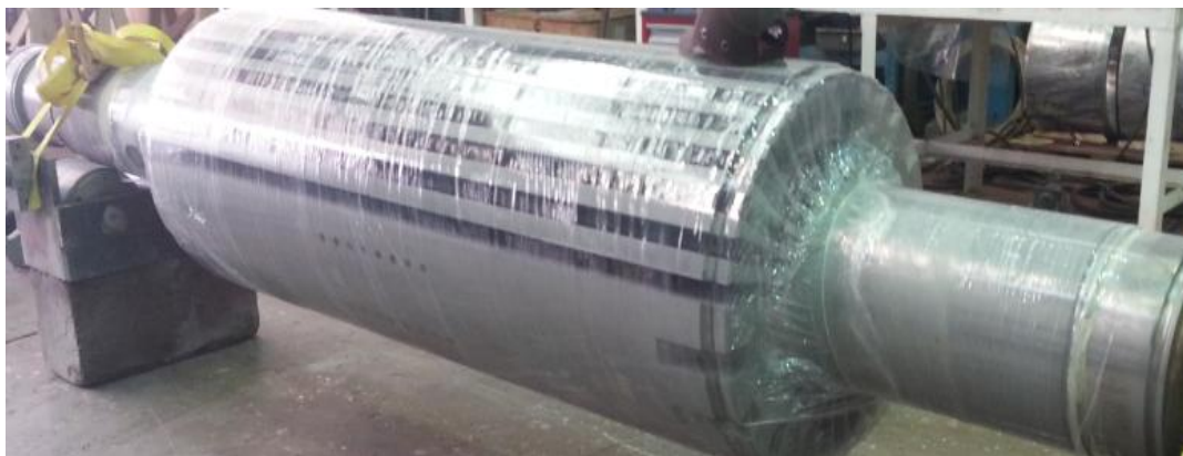
Figure I(14) : Rotor à pole lisse [27]
