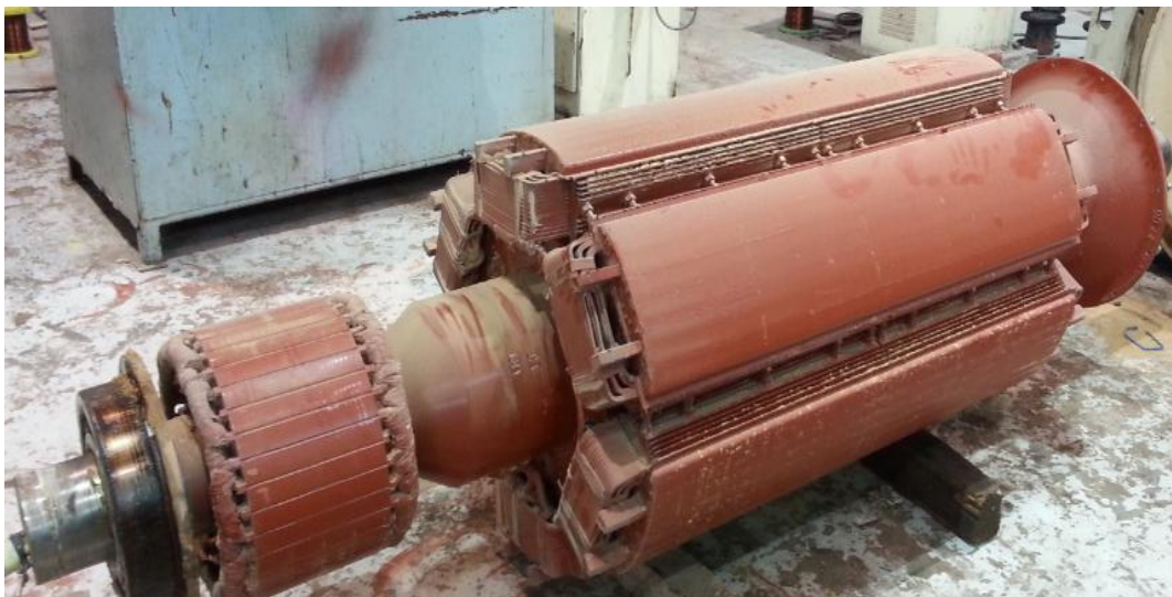
Figure I(13) : Rotor à pôle saillant [25]
