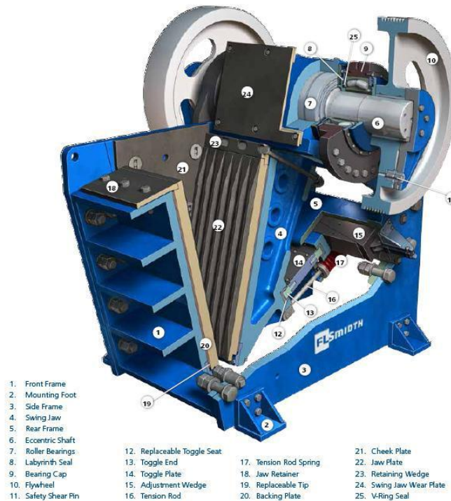
Figure II.8: concasseur a mâchoire[7]
