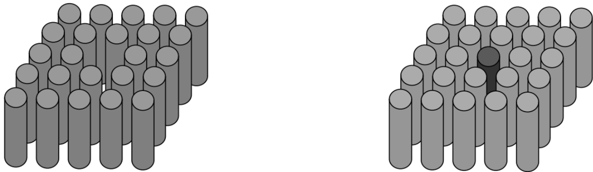
Figure .II. 16 Exemples de défauts ponctuels dans un cristal électromagnétique composé de tiges diélectriques. (a) retrait d'un cylindre, (b) modification de la constante diélectrique d'un cylindre.
