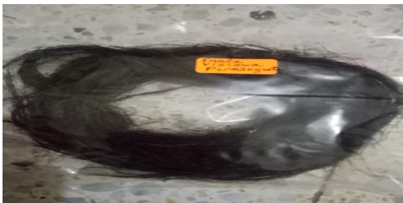
Figure. IV. 2 : Fibres d'Inula Viscosa traitées par le permanganate de potassium
