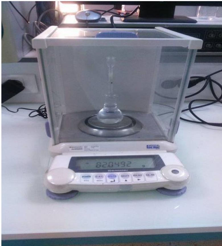
Figure. IV. 7 : Balance électronique : masse de (pycnomètre + Méthanol).
