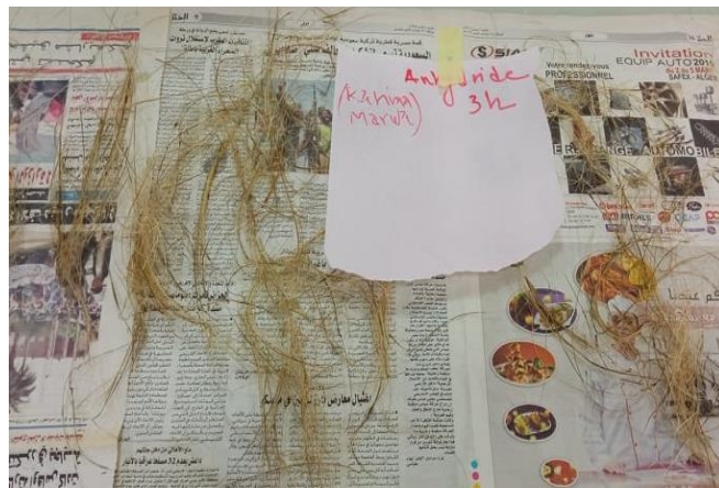
Figure. IV. 3 : Les fibres d'IV traitées par l'anhydride acétique
