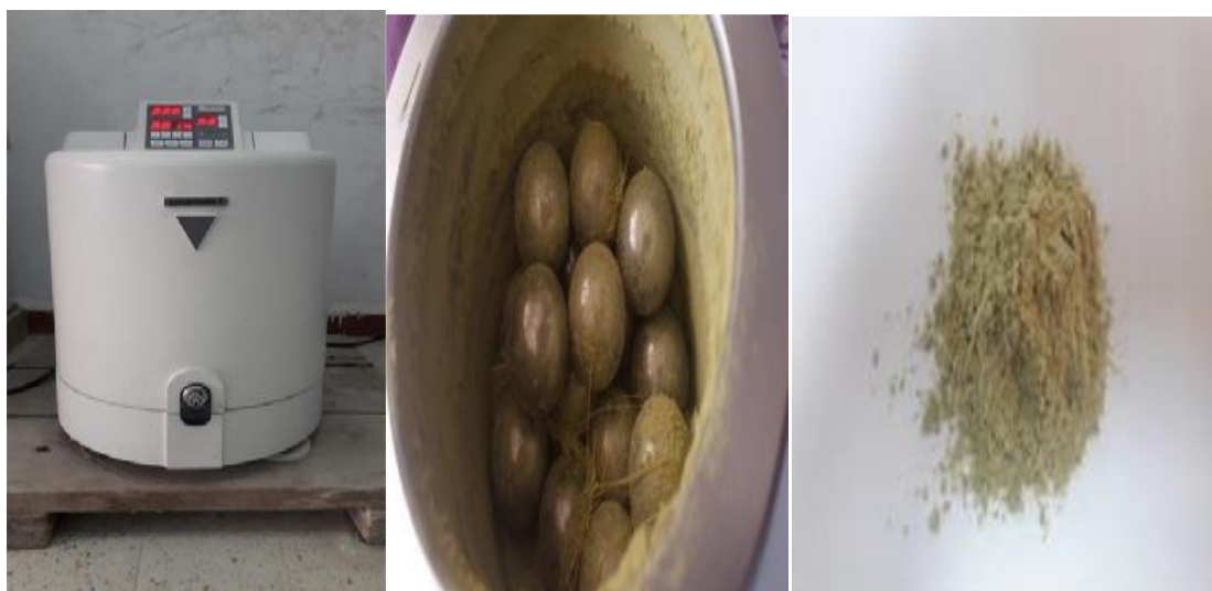
Figure. IV. 4 : Broyage Des fibres : a) Broyeur planétaire b) les billes du broyeur c) la poudre des fibres broyées.
