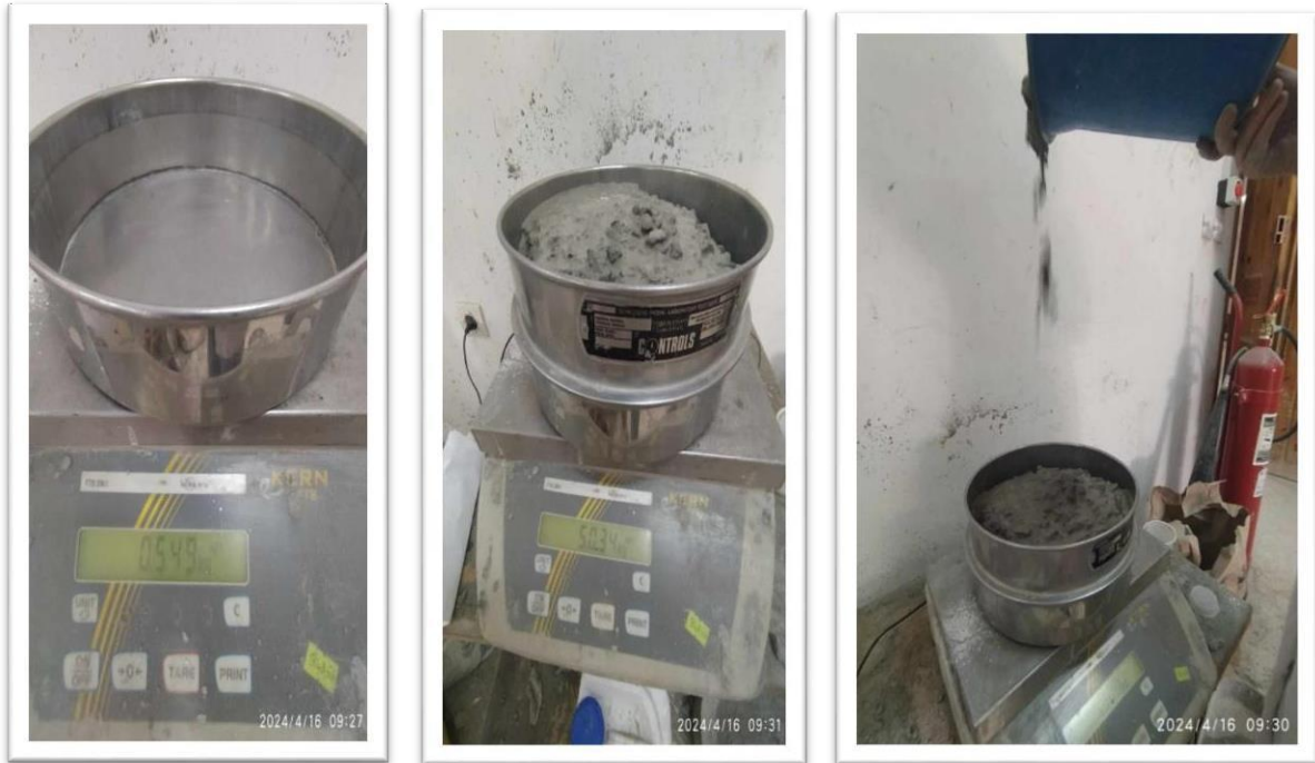
Figure 40 : Principe de l'essai stabilité de tamis sur BAP
