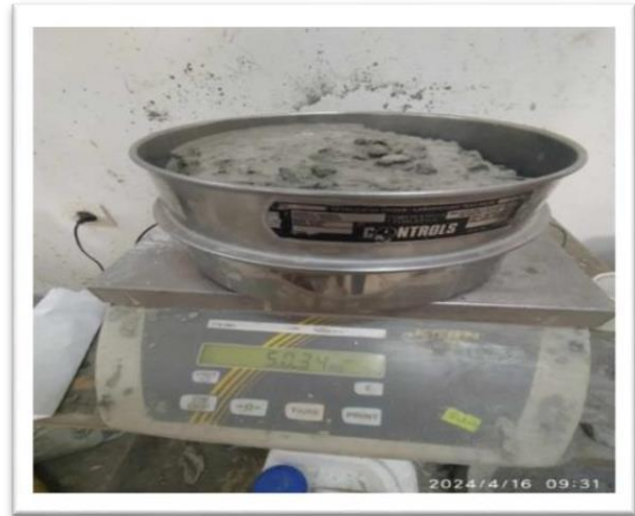
Figure 06 : Représentation de l’essai de stabilité au tamis [20]
