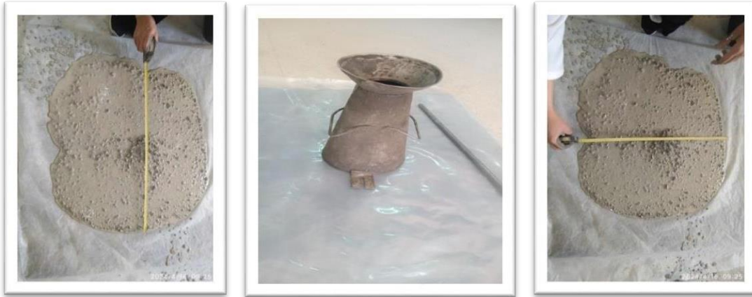
Figure 39: Essai d'étalement au cône d'Abram's
