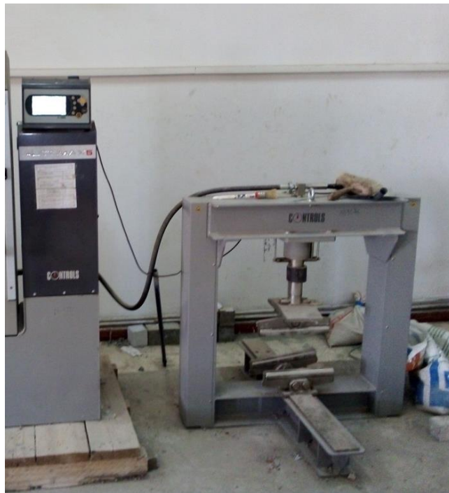
Figure 43:essai de traction et flexion et éprouvette
