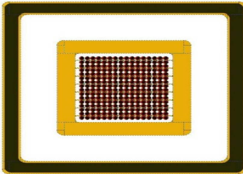
Figure 1.14: un SiPM avec la cathode (cadre interne) et l'anode (cadre externe).
